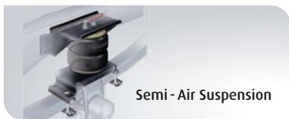
Les renforts de suspension Semi-Air peuvent être installés sur la majorité des véhicules utilitaires, camping-cars, 4X4 et monospaces qu'ils soient d'origine à lames ou ressorts hélicoïdaux. Les coussins double convolute ou diaphragmes sur pistons apportent confort, anti-roulis mais aussi tenue à la charge quelques soient les conditions de route.
